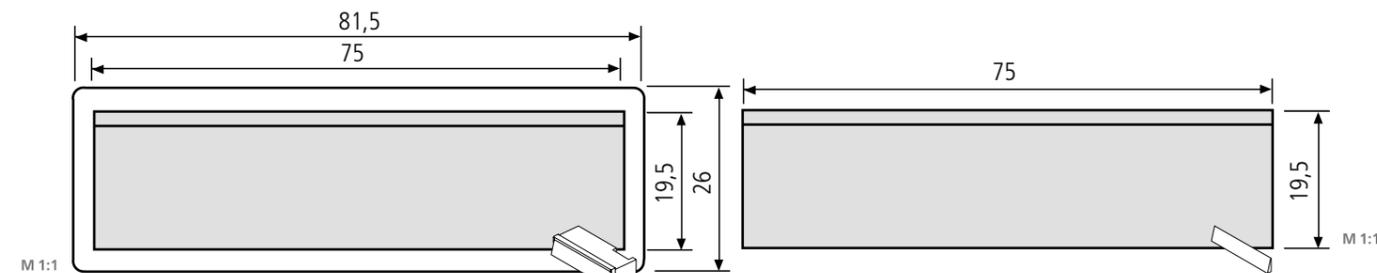
**ALU-RSA2 LED-Beleuchtung**, weiße LEDs, 0,25 W, AC/DC, 12 V, komplett mit Montagegehäuse
