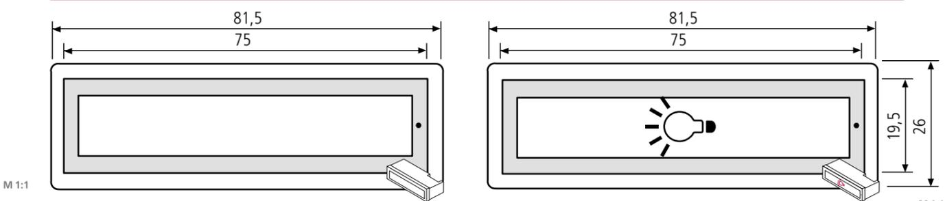
**Kunststoff-RSA2 Namensschild** für RSA2-Klingel **mit LED-Beleuchtung**, Anschluss 12 V, 0,12 Watt AC/DC mit Montagegehäuse, Einlage max. 65 x 13,6 x 1 mm
