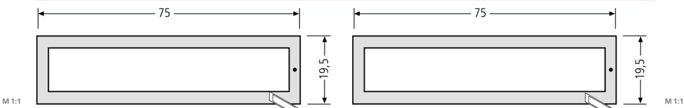
**Kunststoff-RSA2 Namensschildabdeckung** für **unbeleuchtetes** Schild 97-9-85356, 97-9-85368, Einlage max. 65 x 13,6 x 1 mm
