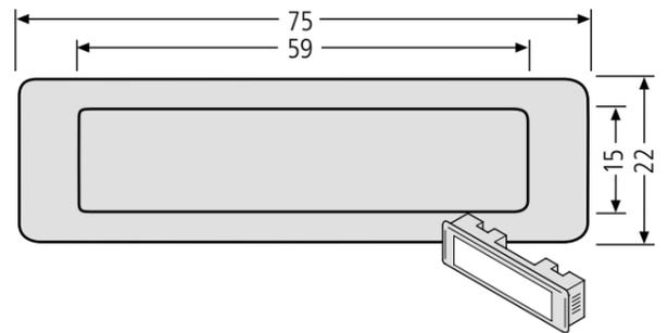
**Kombitaster Lira – Einbau ab 1984 –** Kunststoffrand braun, weiß, oder grau Abdeckung glasklar, Namensschiele einlage max. 55 x 13 x 1 mm, Ausstanzung 71,3 x 19,3 mm, optional beleuchtbar mit Fadenglühbirne 97-9-85033
