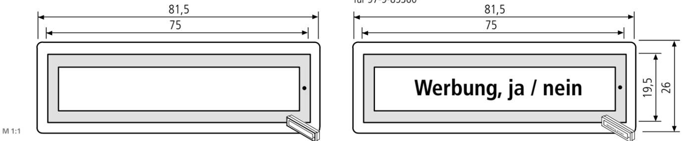
**Kunststoff-RSA2 Namensschild ohne** Beleuchtung, mit Montagegehäuse, Einlage max. 65 x 13,6 x 1 mm
